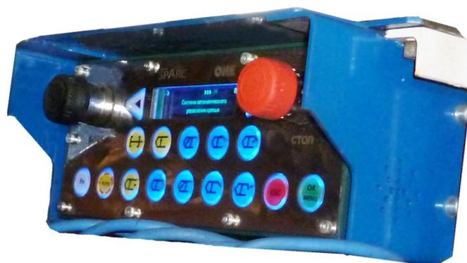
Система выполняет функции управления гидрооборудованием крепи в **ручном** и **автоматизированном** режимах. Система позволяет управлять, как отдельной секцией крепи удаленно, так и группой секций по заданному автоматическому алгоритму.
