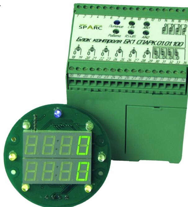
Аналоговые входа **БК1** предназначены для подключения к датчикам тока или напряжения. Дискретные выхода предназначены для контроля за состоянием устройств, контактов реле, предохранителей с выходным напряжением от 0 – 127 В переменного тока.
