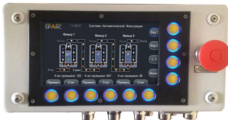
Аппаратура **SAFsystem** при помощи электрогидроклапанов управляет процессом обратной промывки автоматической фильтровальной станции, а также при помощи датчиков давления либо индикаторов загрязнения контролирует параметры фильтров обратной промывки.
